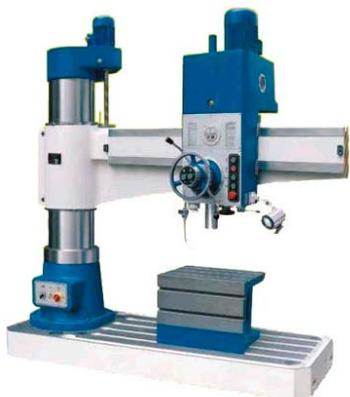
Наружная колонна имеет возможность поворота до  $\pm 180$  градусов. На колонну устанавливается рука. Рука перемещается по колонне вверх/вниз при помощи электродвигателя подъема/опускания, величина хода контролируется концевиками.
