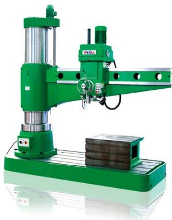
Станок радиально сверлильный Z30100 (аналог 2М57, 2А576) предназначен для обработки отверстий в средних и крупных деталях. На станках можно выполнять следующие виды работ: сверление, зенкерование, развертывание, подрезку торцов и нарезание резьб.
